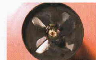
Stauscheibe mit Standard-Heizöl
